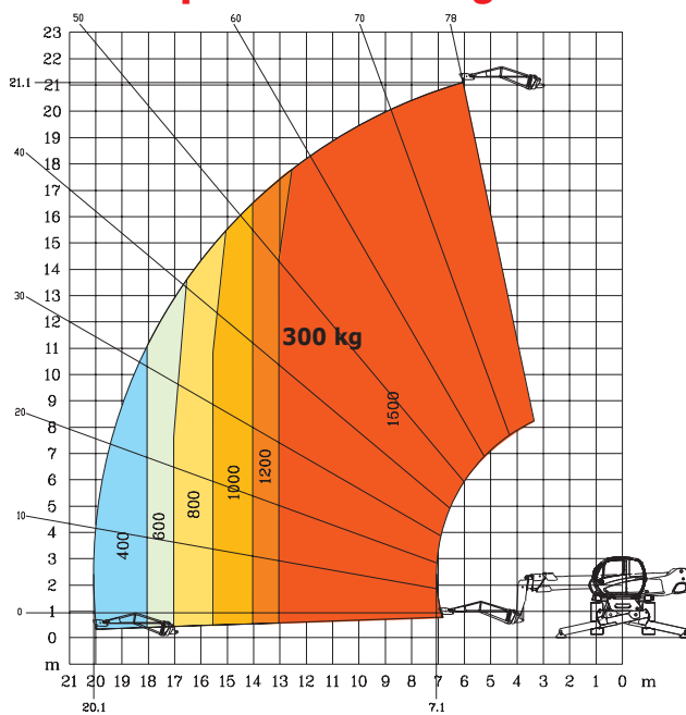
Rotation sur stabilisateurs déployés 3D positif / négatif
